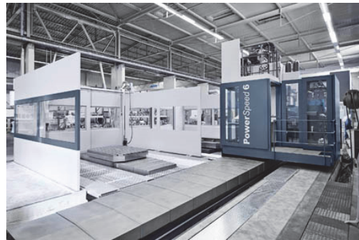
Bild Nr. 07-02 SH_BT- PowerSpeed6-back.jpg. Das Maschinenbett auf der PowerSpeed 6 wurde auf 1220 mm verbreitert. Dadurch lässt sich die Quattro-Energiekette der X-Achse in das Maschinenbett integrieren.
