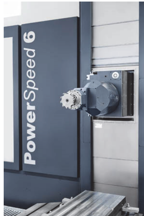
Bild Nr. 07-06 SH_BT-OKopf.jpg. Seit 50 Jahren Kernstück der Maschinen: Von SHW erfundener kompakter und kraftvoller Orthogonalkopf, der 64.800 Positionen anfahren kann.
